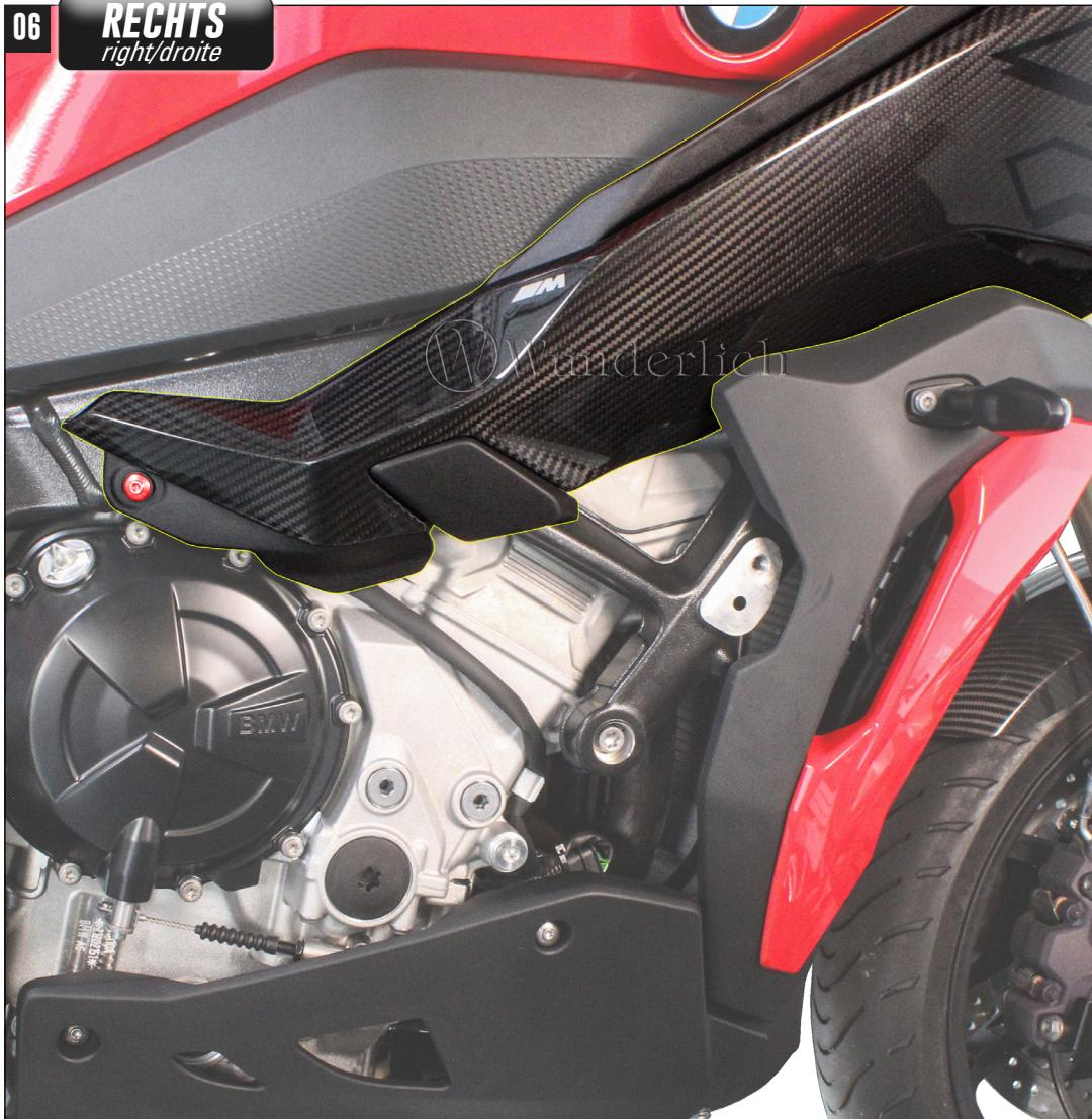
DIE MONTAGE DER RECHTEN SEITE IST IDENTISCH. EINIGST DIE SEITENVERKLEIDUNG IST NUR MIT EINER SCHRAUBE BEFESTIGT.
