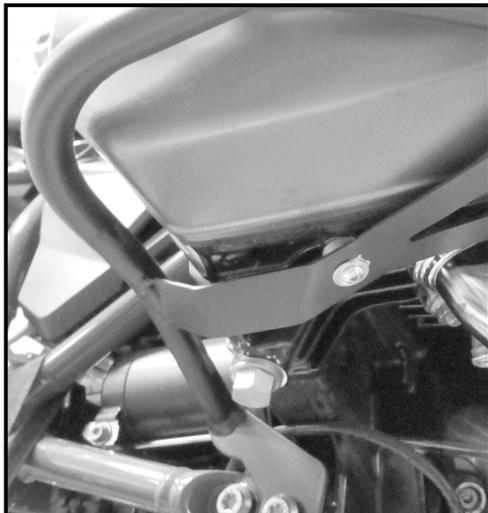
Nun die Sturzbügel rechts und links von unten mit den VA - Linsenkopfschrauben M5x8 sowie den VA-Karosseriescheiben Ø5,4 in den bereits vormontierten Silentblöcken verschrauben.
