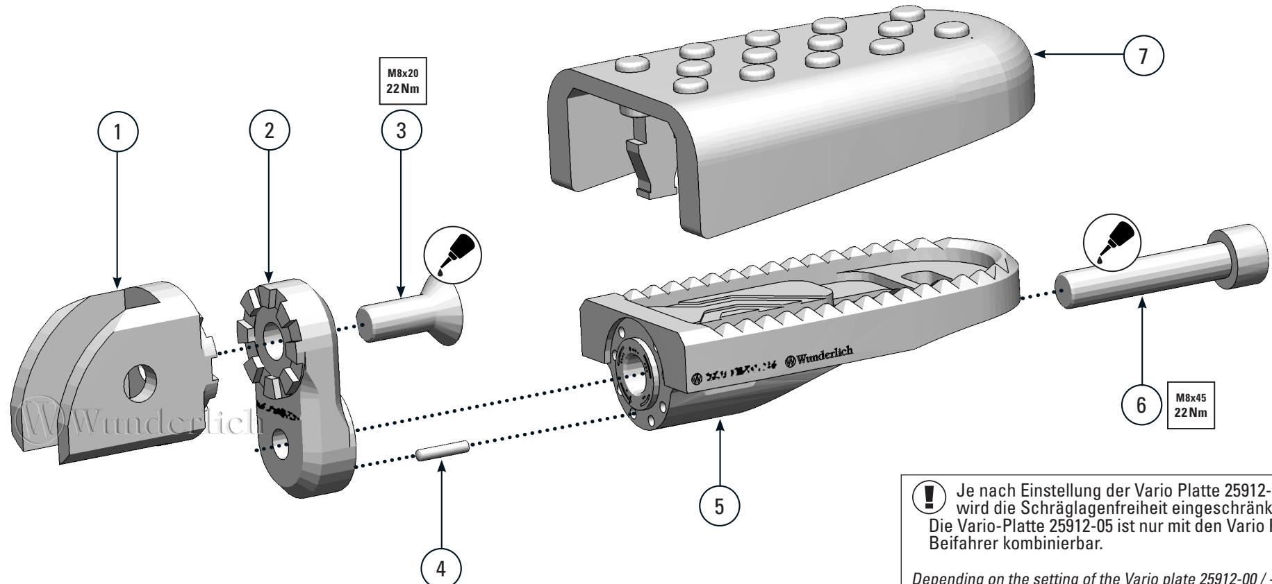
! Je nach Einstellung der Vario Platte 25912-00 / -03, wird die Schräglagenfreiheit eingeschränkt! Die Vario-Platte 25912-05 ist nur mit den Vario Fußrosten Beifahrer kombinierbar.
