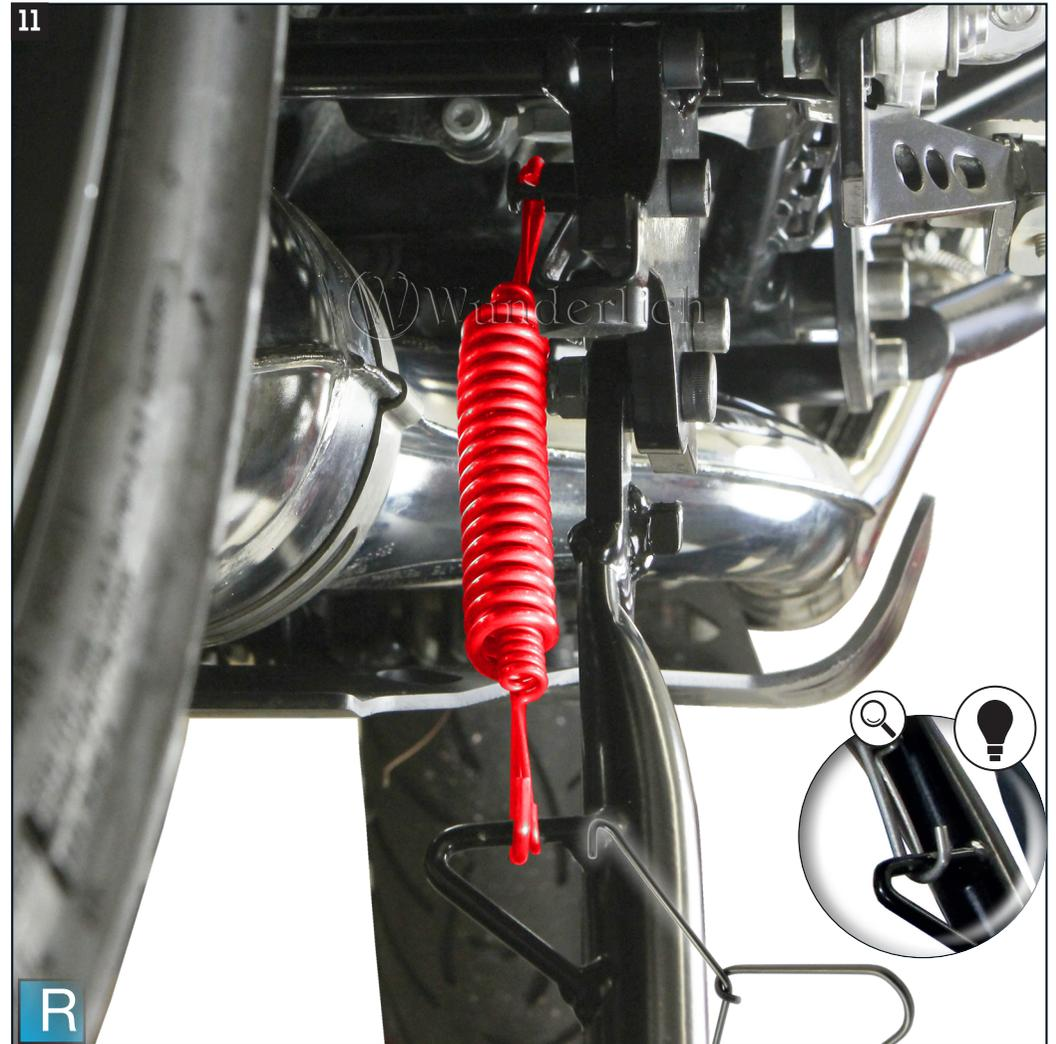
**Spannfedern nacheinander mit Federzieher einhängen. Alle Schrauben festziehen und den Hauptständer auf Freigängigkeit prüfen!**
