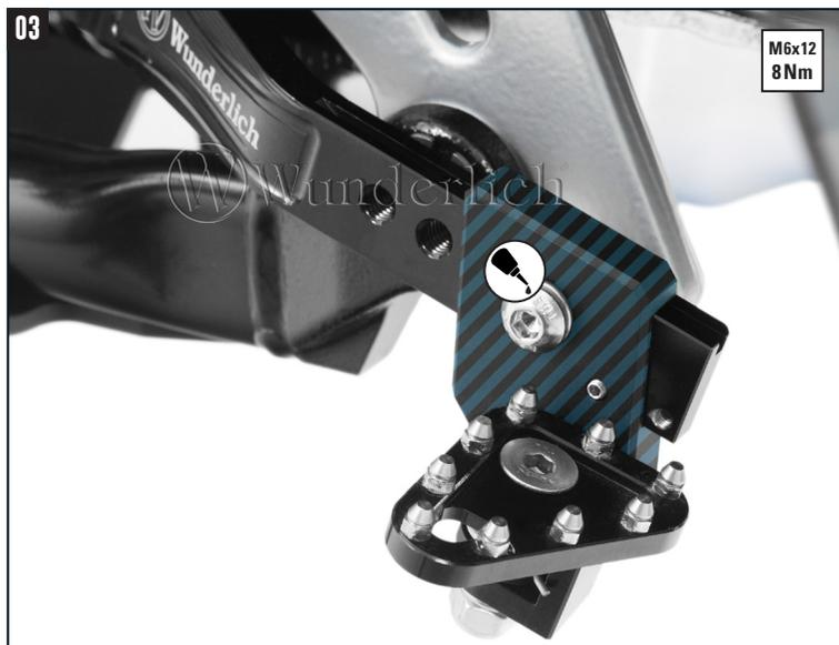
Senkkopfschraube (M6) handfest anziehen und die Klappfunktion prüfen, danach kontern! Bremshebeltieferlegung einstellen, danach Linsenkopf- sowie die Madenschraube mit Schraubensicherung (mittel) einkleben.
