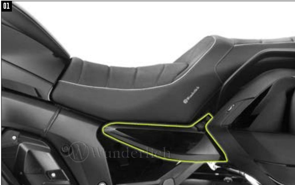
**01** K 1600 Bagger Seitenverkleidung demontieren!
