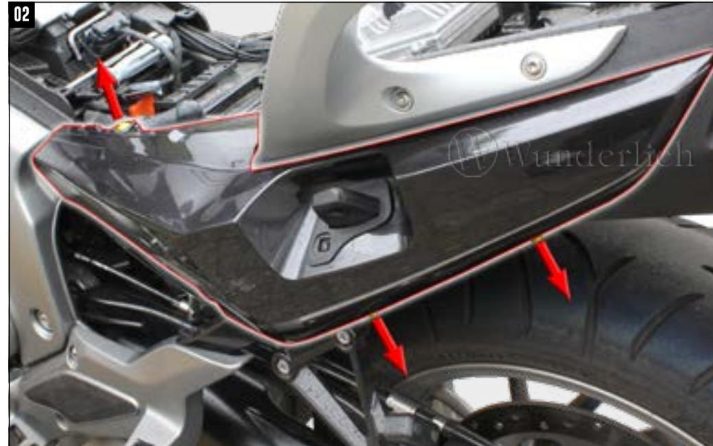
**02** K 1600 GTL Seitenverkleidung demontieren!
