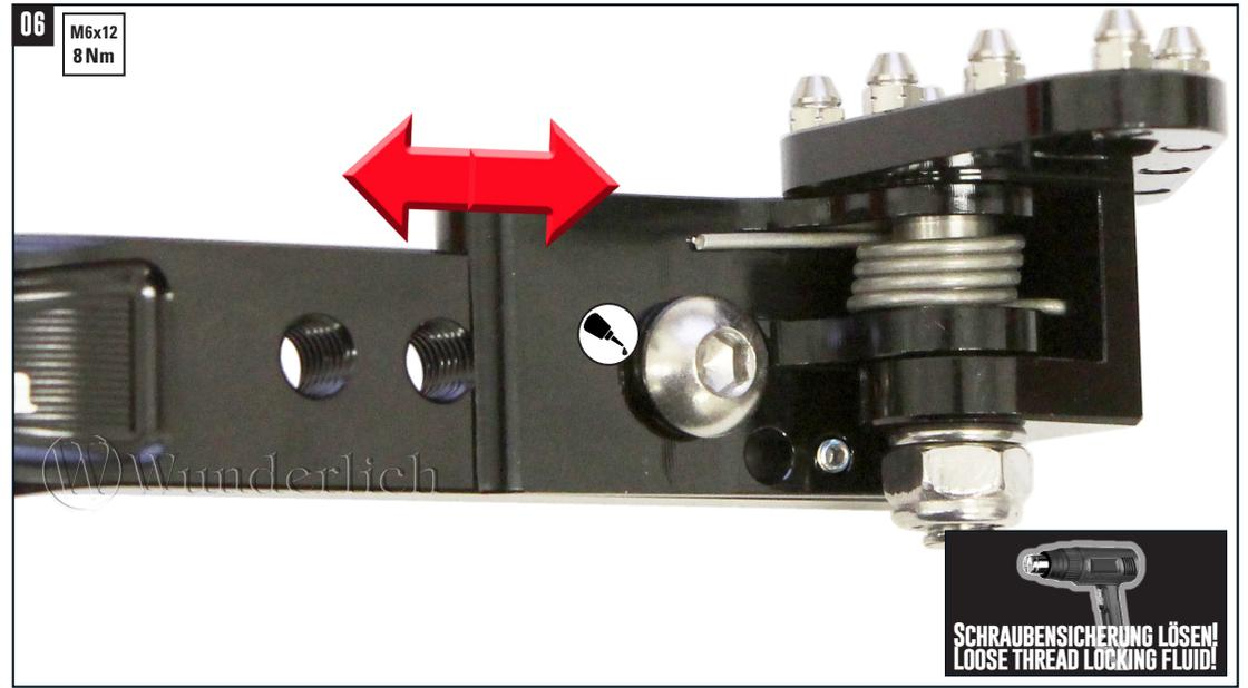
**Bremsehebel einstellen, Linsenkopfschraube sowie die Madenschraube mit Schraubensicherung (mittel) einkleben.**
