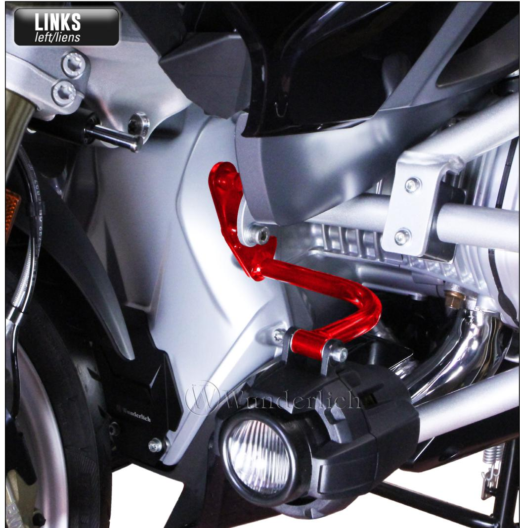
**Vorab den orig. Halter der Zusatzscheinwerfer demontieren und an den Schutzbügel montieren. Gegebenenfalls Kabelbinder der Kabelführung lösen!**
