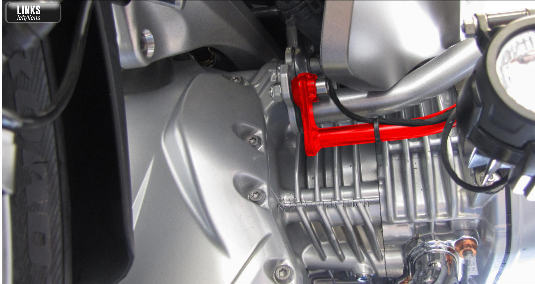
Gegebenenfalls Kabel mit Kabelbinder fixieren!
