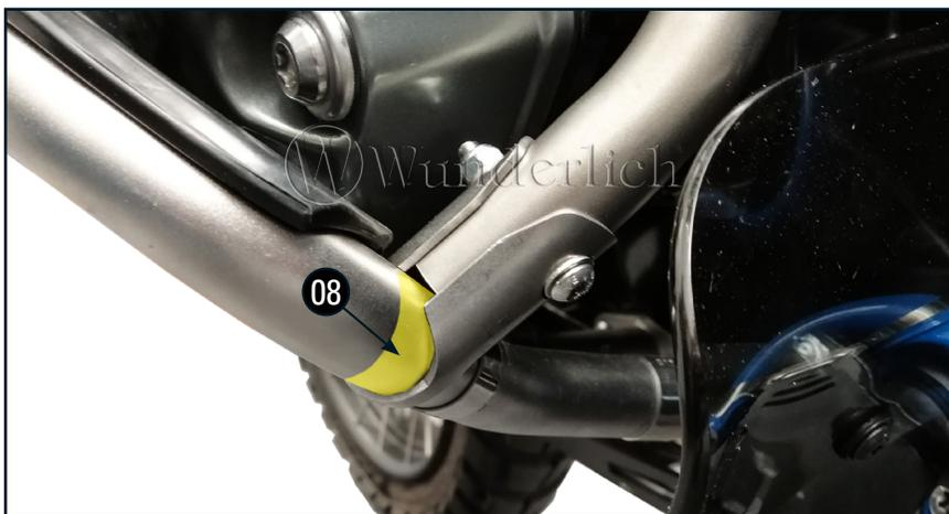
**Der kürzere der beiden Verstärkungsbügel (1) ist für die (in Fahrtrichtung) linke Seite.**
