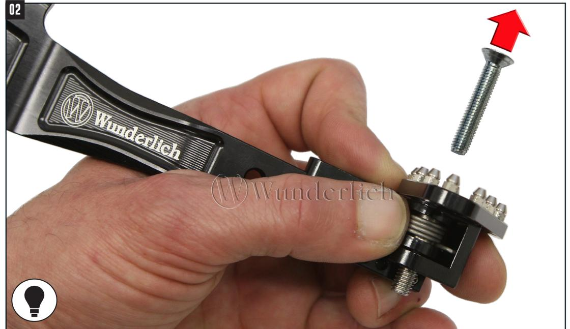
**Halten Sie die Bremshebelauflage mit Feder und Hülse in Position und entfernen die Senkkopfschraube (M6x30).**
