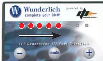
**Vollgas:** Die roten LED leuchten bei Vollgas auf (ab etwa 5500 UPM). Je nach Drehzahl leuchten mehr LED auf.
