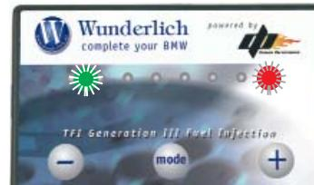
**Verzögerung:** Wenn der Gasgriff bei Fahrt geschlossen wird, blinken manchmal beide äußeren LED (rot & grün) und zeigen so, dass die Injektoren geschlossen sind.
