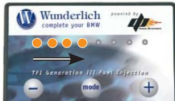
**Beschleunigungspumpe:** Bei starker Beschleunigung leuchten die gelben LED auf (je nach Drehzahl leuchten mehr).
