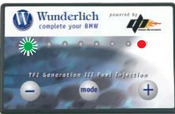
**Fehlermeldung:** Die grüne LED blinks und die rote leuchtet. D.h. der „PC.“ ist angeschlossen, aber empfängt kein Injektoren-Signal.
