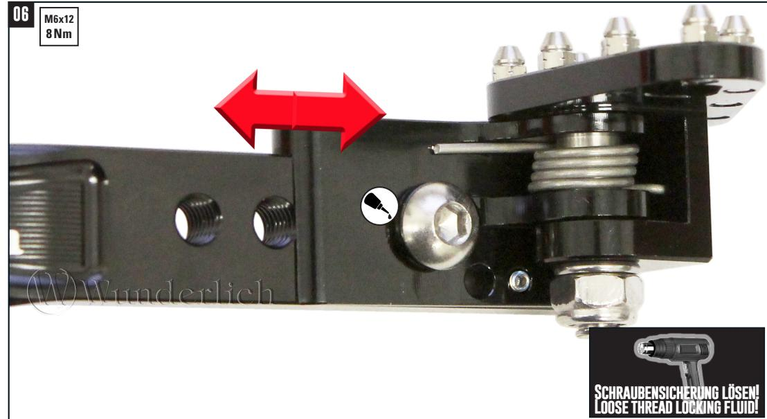
Bremshebel einstellen, Linsenkopfschraube sowie die Madenschraube mit Schraubensicherung (mittel) einkleben.
