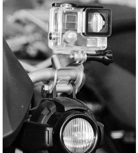
Befestigen Sie das CamRack mit der beiliegenden Schraube M6 x 45 an der Halterung der Zusatzleuchte. Die U-Scheibe [1] wird unter der original Sechskant-Mutter verbaut.
