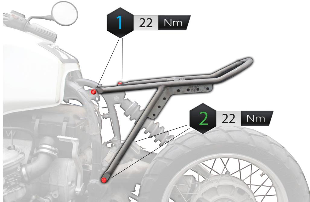
Lackieren Sie den Rahmen erst nachdem Sie ihn zur Probe montiert und ggf. angepasst haben.
