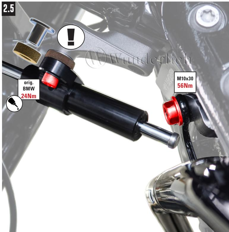
**ZUR MONTAGE VORNE OBEN, MUSS MODELLABHÄNGIG DER LENKUNGS-DÄMPFER GELÖST WERDEN (AUF DIE RICHTIGE POSITION DER MOOSGUMMISCHEIBE UND STUFENHÜLSE ACHTEN). MOTORSCHUTZ LOCKER VORMONTIEREN, AUSRICHTEN UND ZULETZT DIE SCHRAUBEN MIT ANGEgebenEN DREHMOMENT ANZIEHEN.**
