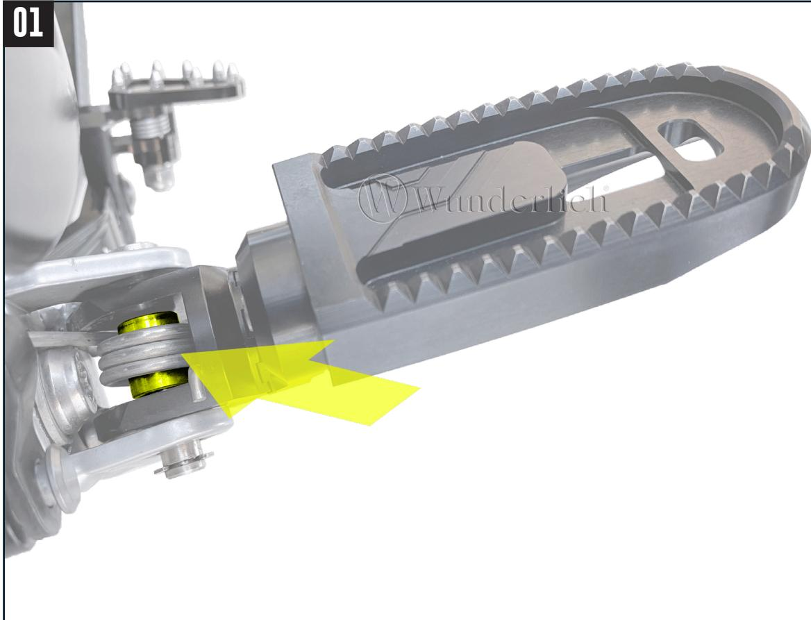
**Bei werkseitig verbauten Enduro Fußrasten müssen die beigelegten Hülsen verwendet werden (Bild1). Außerdem bleiben die Rückstellfedern in Originalposition.**
