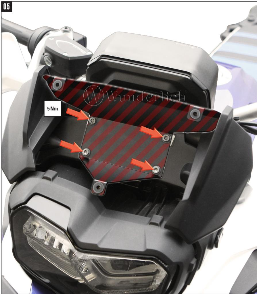
**DE VERWENDEN SIE JE NACH AUSSTATTUNG DIE ORIG. BMW SCHRAUBE (M6x40) ODER DIE BEILIEGENDE ZYLINDERSCHRAUBE M6x20.**
