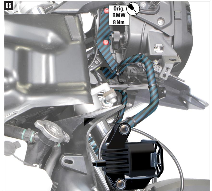
**DE** Zusatzscheinwerfer mit Halter montieren und anschließen (Anschlußplan Seite 3). Verkleidung in umgekehrter Reihenfolge montieren.
