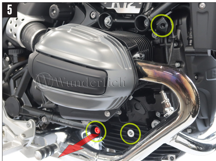
M12 Gewindebohrung, alte Schraubensicherungsreste entfernen. M12 threaded hole, remove old screw locking residue. Trou fileté M12, enlever le résidu de blocage de l'ancienne vis.
