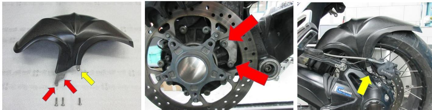
**Bitte achten Sie auf genügend Freiraum zu allen umliegenden fest und beweglichen Bauteilen. Bitte ziehen Sie zuerst Schritt für Schritt alle montierten Schrauben handfest an, nach der Kontrolle des korrekten Sitzes des Bauteils ziehen Sie bitte alle Schrauben unter Einhaltung und Vorgabe der originalen Anzugsdrehmomente fest.**
