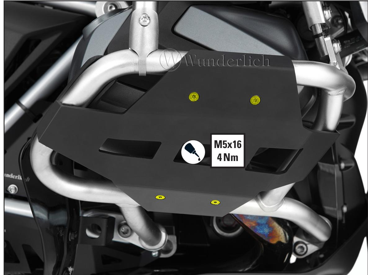
**Vor dem Festziehen den korrekten Sitz des Zylinderkopfschutzes zum Motorschutzbügel überprüfen.
