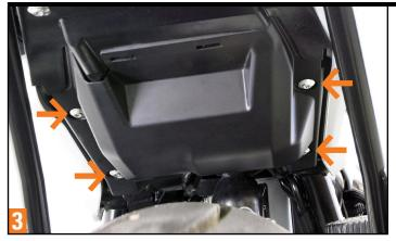
Lösen und entfernen Sie die vier in Abbildung 3 markierten Schrauben mit einem T-25 Torx Schraubendreher. Diese Schrauben werden nicht wieder benutzt.
