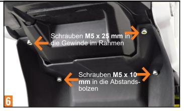
Positionieren Sie die U-Scheiben über den M5 Torx Schrauben. Führen Sie die Schrauben M5 x10 durch die vorderen Bohrungen im MudSling und weiter in die Gewinde der Abstandsbolzen sowie die Schrauben M5 x 25 durch die hinteren Bohrungen des MudSling in Gewinde am Rahmen. Ziehen Sie alle vier Schrauben an.
