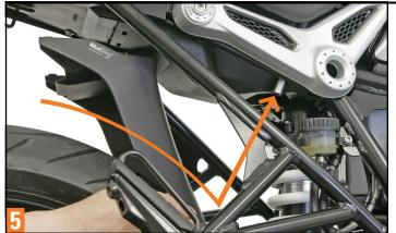
Führen Sie den MudSling von hinten unter die vorderen Befestigungspunkte. Richten Sie Bohrungen im MudSling auf die Gewinde zur Befestigung aus wie abgebildet.
