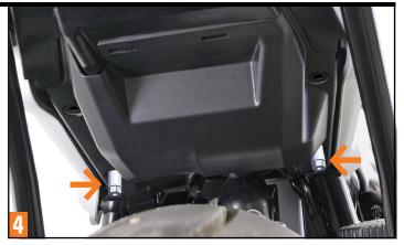
Montieren Sie die M5-Abstandsbolzen in der abgebildeten Position und ziehen Sie diese mit einem 10 mm Steckoder Maulschlüssel fest.
