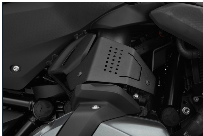
Die Einspritzanlagen-Abdeckung schützt gegen Manipulation der Anlage und der Steckverbinder (Art.-Nr.: 42940-602)
