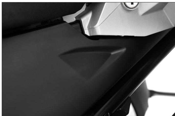
Stabilität und Bauteilsteifigkeit: Hochwertiger PP-Kunststoff - mit 3 mm Bauteilstärke großzügig dimensioniert
