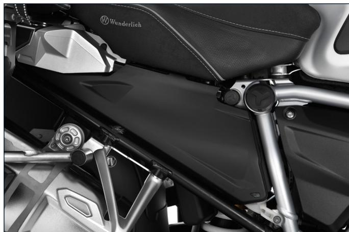
Aufgewirbelter Schmutz, Steinschlag, Spritzwasser oder Gischt werden effektiv aufgefangen bzw. abgeleitet
