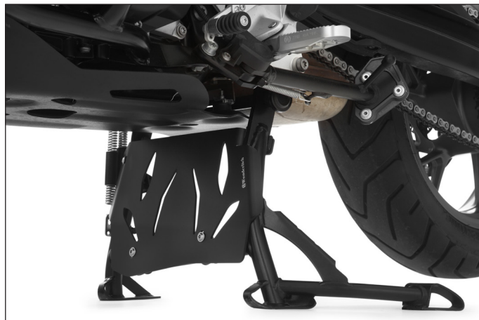
Wunderlich Hauptständerschutzplatte für die BMW F 750 GS (Art.-Nr.: 25852-102)
