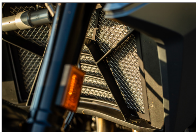
Rahmen und Stege bestehen aus schwarz pulverbeschichtetem Aluminium, das engmaschige Gitter ist aus Edelstahl gefertigt
