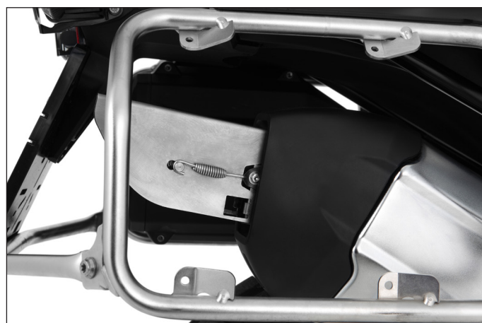
Der »GONZZOO« schirmt die Koffer vor der Hitzeabstrahlung des Abgasstroms ab und verringert das Aufheizen des Inhalts
