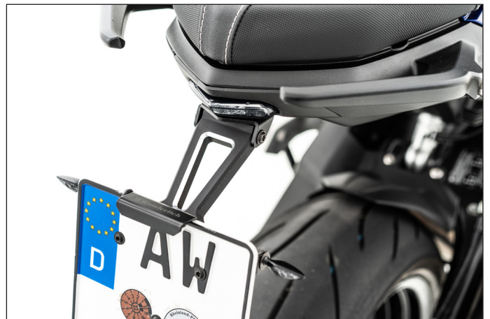
... sie ist gleichzeitig die Basis zur Aufnahme des puristischen Rücklichts und des Kennzeichenträgers. Dessen Ausleger besteht aus gefrästem Aluminium
