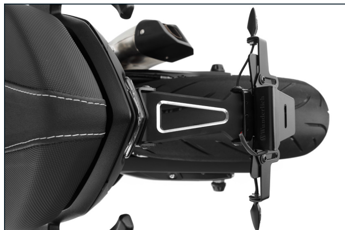
Die Adapterkabel für die Blinker und die mitgelieferte LED-Kennzeichenbeleuchtung (mit E-Prüfzeichen) sind vorbereitet. Sie werden verborgen verlegt
