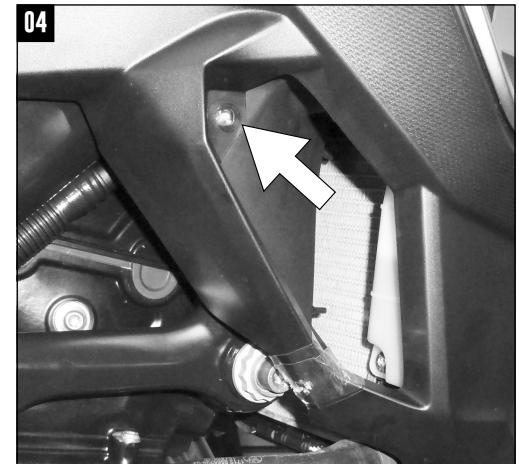
Zur späteren Montage der M12x100 Sechskantschrauben die seitlichen Verkleidungen mit leichtem Druck wegziehen, wenn nötig demontieren.
