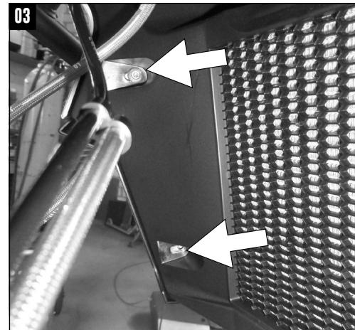
Hierfür die beiden Schrauben auf der Innenseite (Bild 3) und die Schraube außen (Bild 4) lösen.
