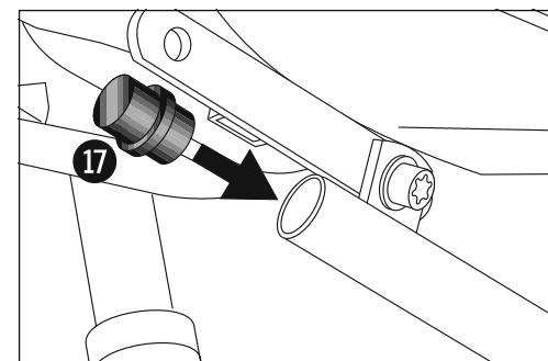
Das Verbindungsstück Ø25 in das Rohrende des montierten linken Motorschutzbügels fügen.
