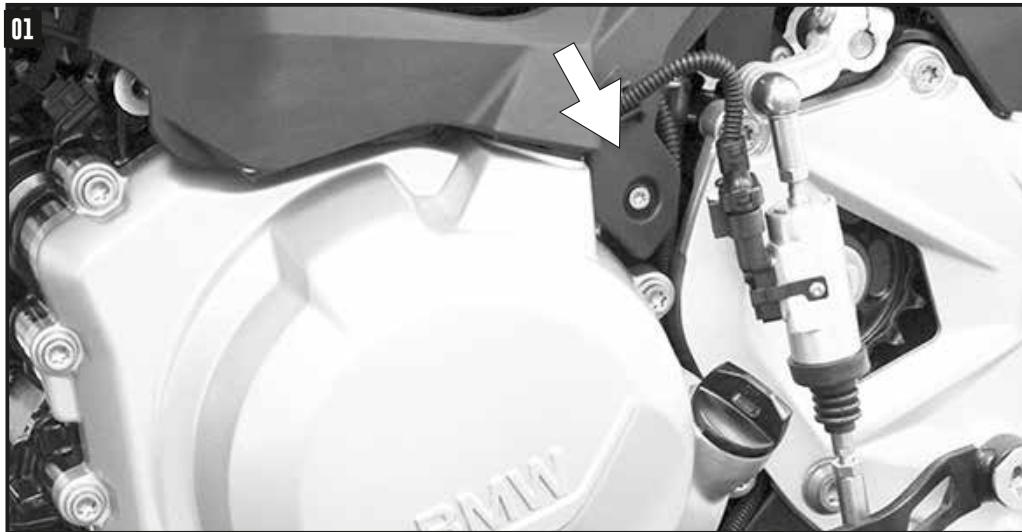
**Linke Seite:** Zur leichteren Montage auf der linken Seite die Kunststoffabdeckung der Kupplungseinstellung lösen. Hierzu den Torxschraube lösen und die Abdeckung von der vorderen Klemmung abziehen.
