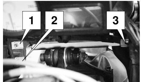
Führen Sie nun das CamRack von unten hinter den Ölkühler an seinen Sitz und befestigen Sie es mit den beiliegenden Schrauben und U-Scheiben.
