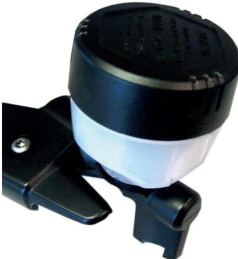
Achtung! Sollten Sie keinen Dichtring vorfinden und sich die Brakebox anschlusseitig vom originalen Behälter unterscheiden (siehe Abb.), ist die an Ihrem Fahrzeug verbaute Bremspumpe nicht für diese Brakebox geeignet. Bitte setzen Sie sich direkt mit uns in Verbindung, ggf. gibt es für Ihr Fahrzeug eine andere Brakebox.
