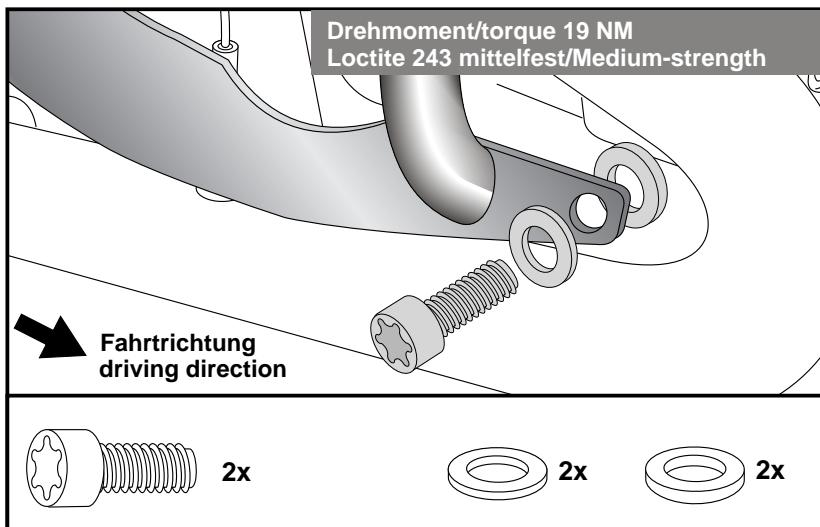
Befestigung des Motorschutzbügels hinten unten links und rechts:
