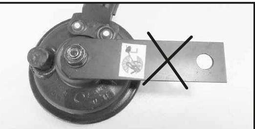
Die Hupe demonterieren, das Halblech entfernen, dieses entfällt und wird durch mitgelieferte Hupenhalterung ersetzt. Die beiden Originalschrauben rechts und links unter dem Cockpit entfernen.
