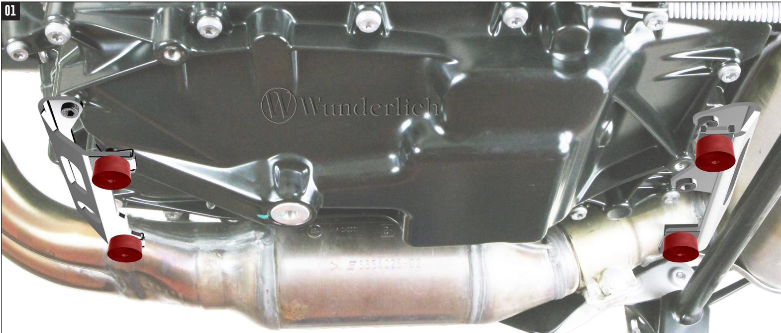
! Die eingesetzten Silentblöcke sind starken Belastungen ausgesetzt und sollten spannungsfrei montiert sein. Bitte überprüfen Sie diese in regelmäßigen Abständen auf Unversehrtheit und bei Beschädigung erhalten Sie Ersatzteile bei unserem Kundensevice.
