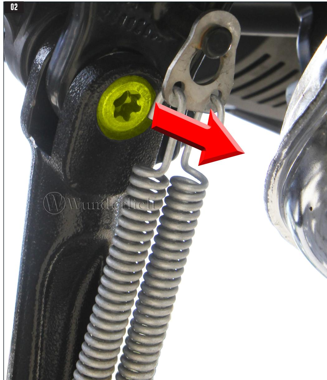
Fahrzeug aufbocken. Seitenständer einklappen und die Federn entfernen. Danach den Seitenständer demontieren.
