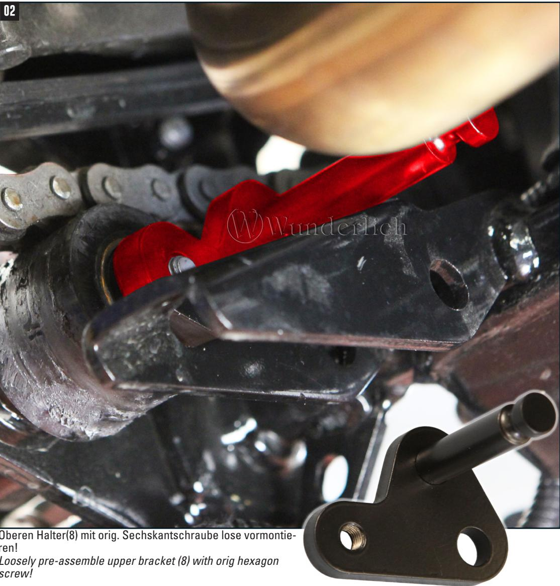
Oberen Halter(8) mit orig. Sechskantschraube lose vormontieren!
