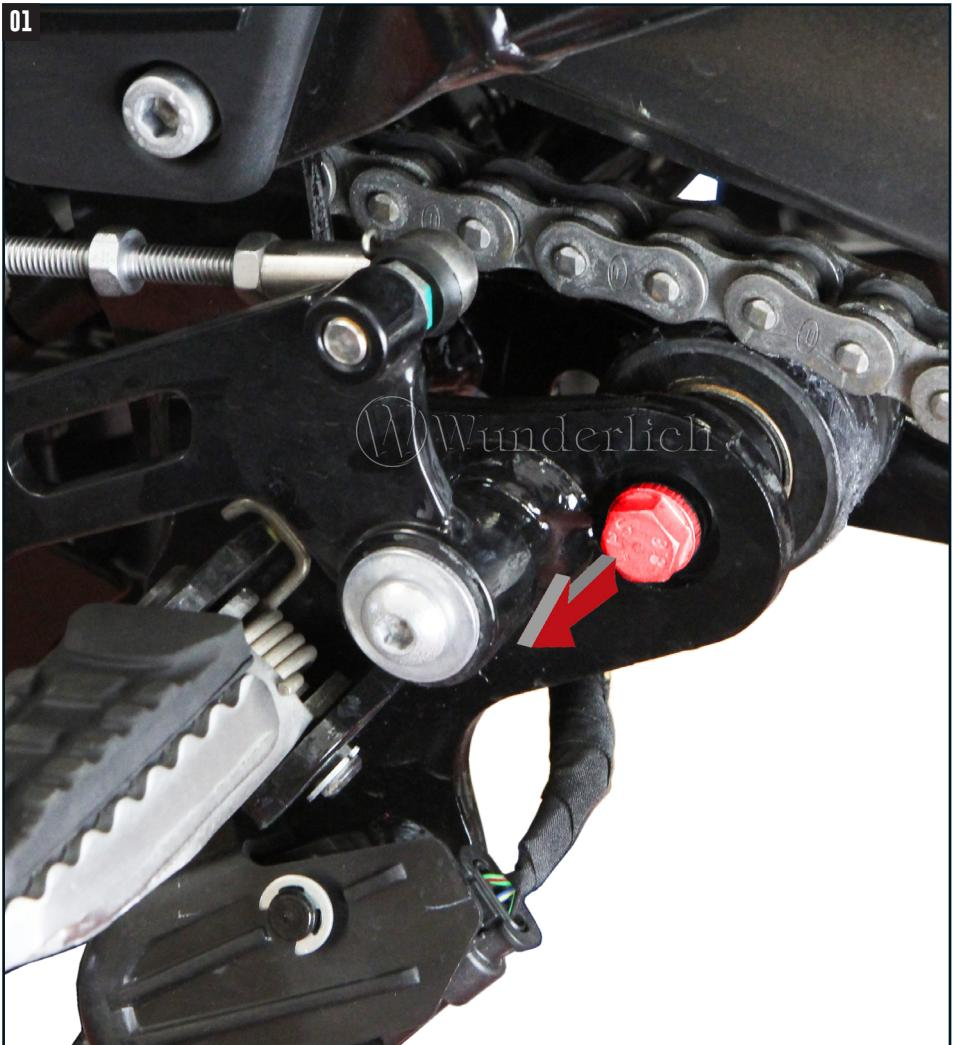
Schraube lösen, innenliegende Kontermutter entfällt!
