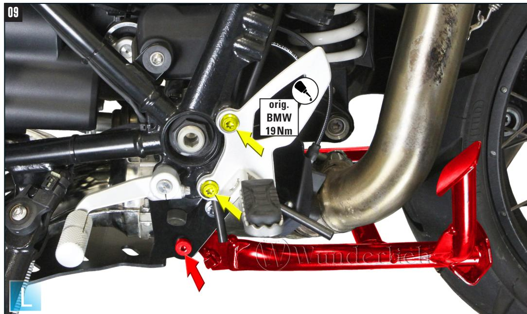
1. Rastenträger montieren 2. Hauptständer lose vormontieren!
