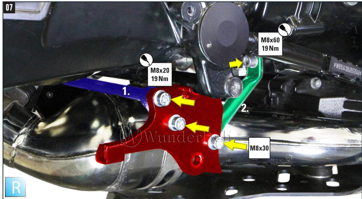
1. Rechten Halter mit der Querstrebe verschrauben. 2. Verdreh sicherung vornontieren und später fest verschrauben!
