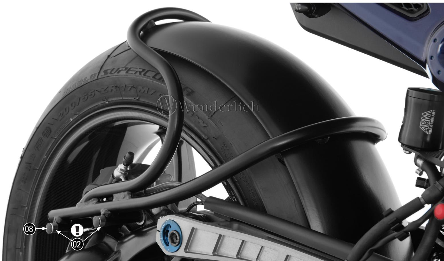
**Bei diesem Heckfender handelt es sich um ein in Handarbeit hergestelltes Produkt, bei dem geringfügiges Anpassen von Nöten sein kann.**
