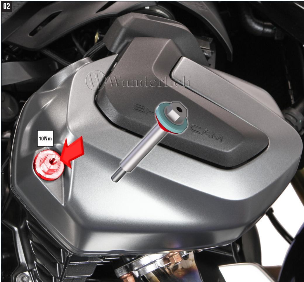
**DICHTUNG DER VENTILDECKELSCHRAUBE EINÖLEN.**
