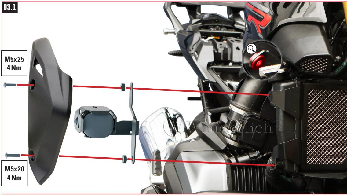
Kühlerblende vor der Montage in die markierte Gummitülle einschieben. Hülsen entfallen bei Edelstahl Kühlerblende.
