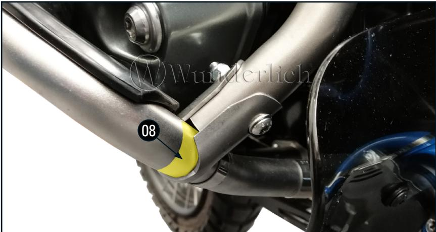
**Der kürzere der beiden Verstärkungsbügel (1) ist für die (in Fahrtrichtung) linke Seite.**
