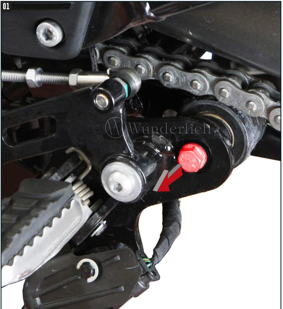
Schraube lösen, innenliegende Kontermutter entfällt!
