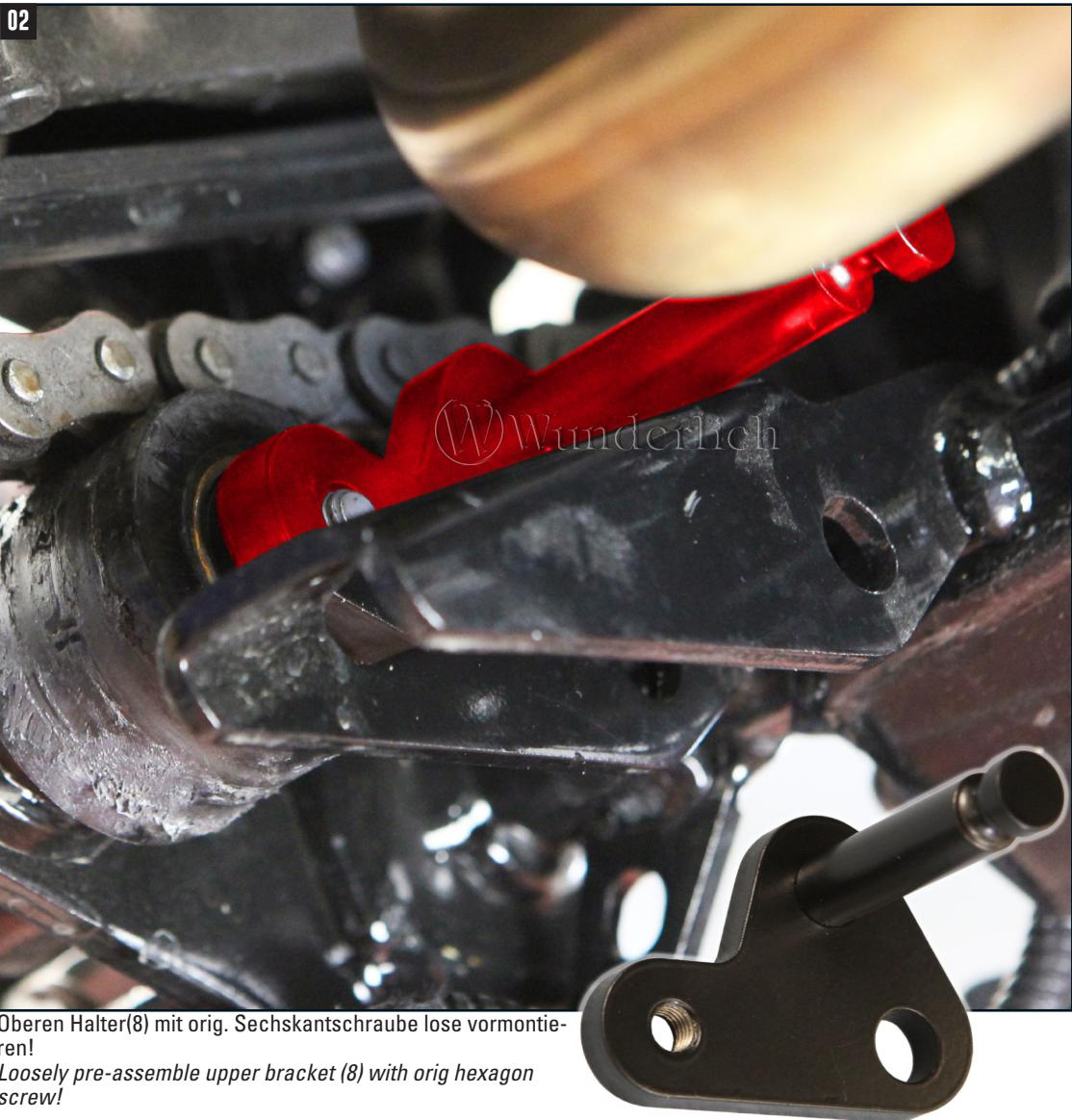
Oberen Halter(8) mit orig. Sechskantschraube lose vormontieren!
