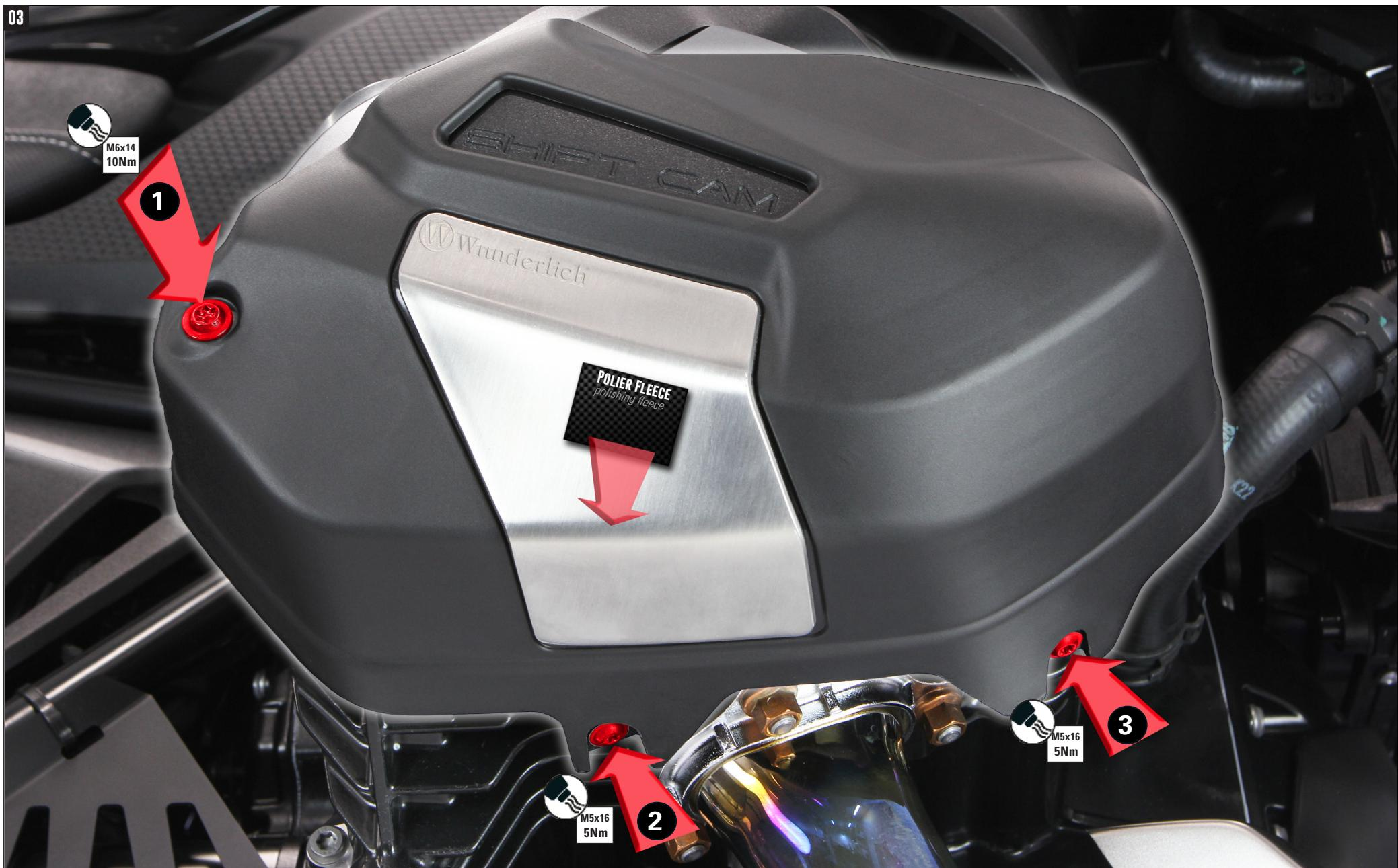
**SCHRAUBEN DER REIHE NACH VORMONTIEREN UND DANACH MIT ANGEgebenEN DREHMOMENT ANZIEHEN.
