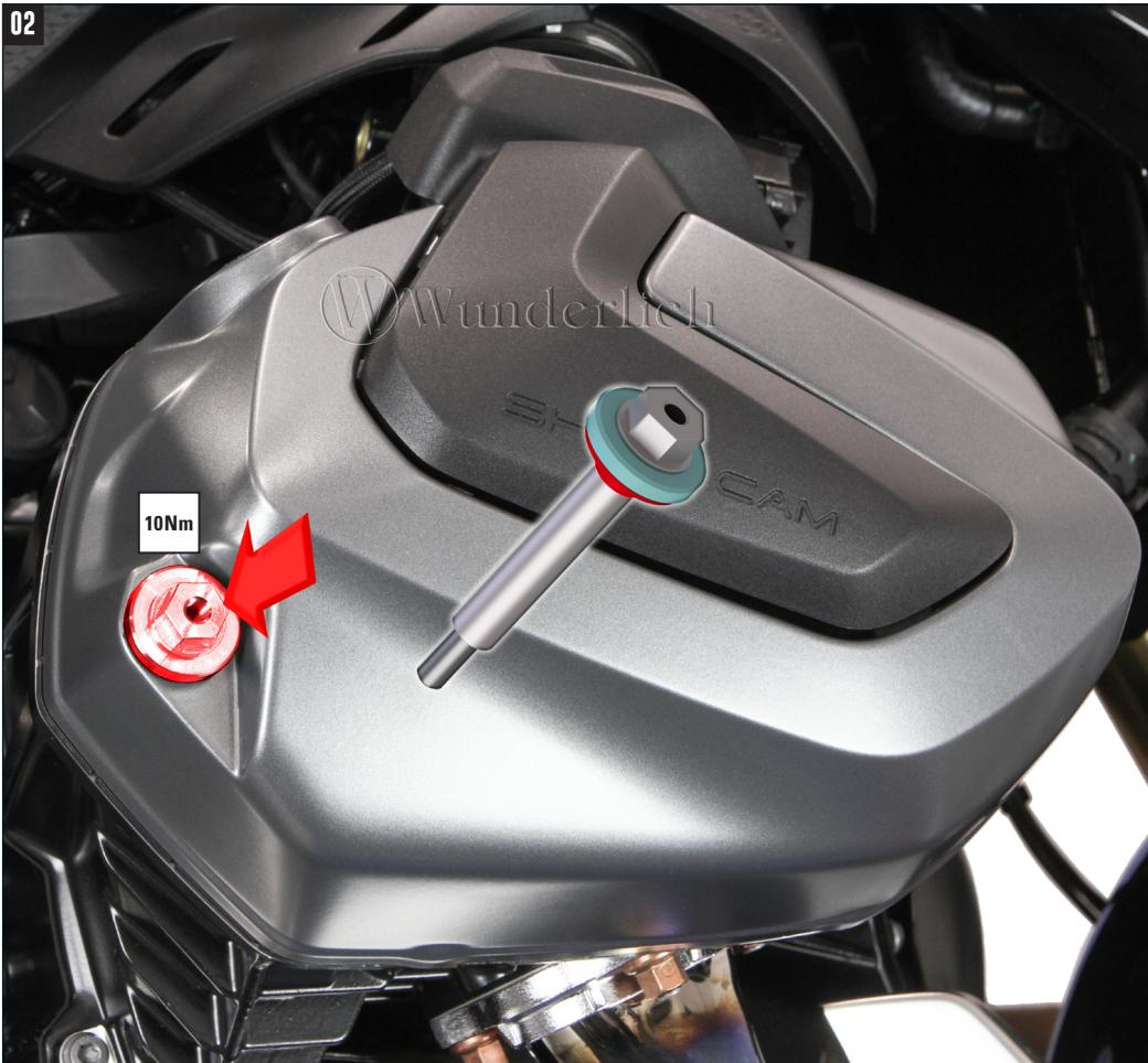
**DICHTUNG DER VENTILDECKELSCHRAUBE EINÖLEN.**
