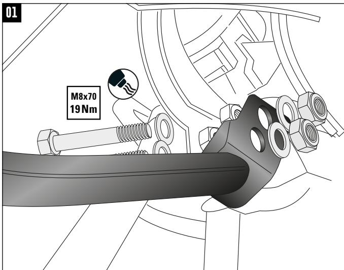
Original-Schrauben unter dem Cockpit am Rahmenkopf entfernen, diese entfallen.
